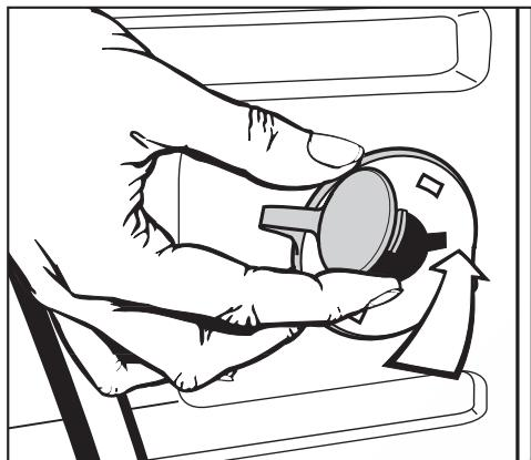
**!** Стиральную машину нельзя будет транспортировать без транспортной блокировки. Сохраняйте транспортную блокировку. Она должна будет опять смонтирована перед транспортировкой стиральной машины (например, при переезде).
